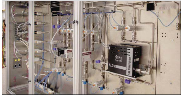
用於Meaglow反應器的金屬有機物蒸汽輸運系統。由於大多數金屬有機物蒸汽不需要再使用-1托左右氣壓的載氣——相對於傳統的MOCVD系統，這樣就能大大簡化蒸汽的輸運系統。
